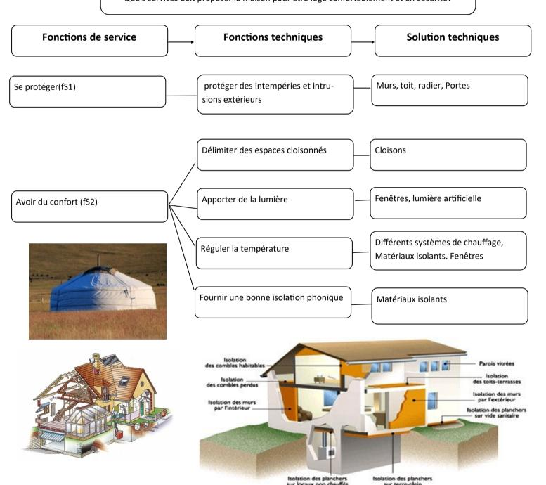
Le diagramme fonctionnel permet de décrire et expliquer le fonctionnement d'un objet technique.
