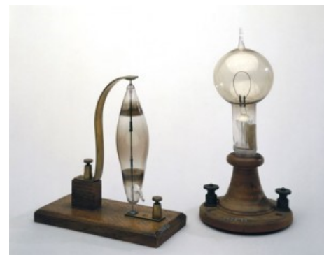
Un prototype de lampe Swan (à gauche) et la première lampe Edison
