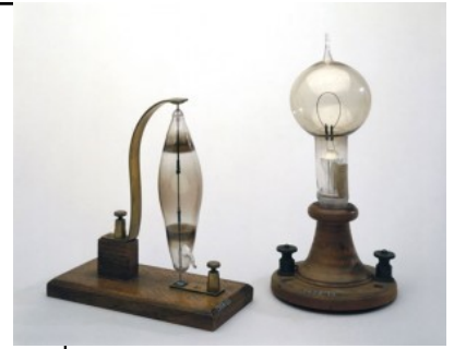
Un prototype de lampe Swan (à gauche) et la première lampe Edison (à droite).
