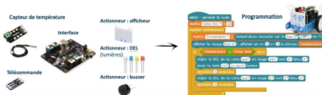
Un capteur est le composant qui réalise l'acquisition d'une grandeur physique (température, luminosité, présence, distance, ...). L'actionneur est le composant qui réalise une action à partir de l'énergie qu'il reçoit.
