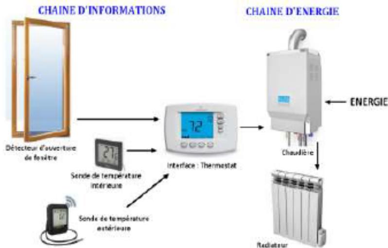
En entrée, le système va recevoir des informations de l'utilisateur (interrupteur, programmation, signal d'une télécommande, ...) ou de son environnement (température intérieure, extérieure, ouverture ou pas d'une fenêtre, ...) .
